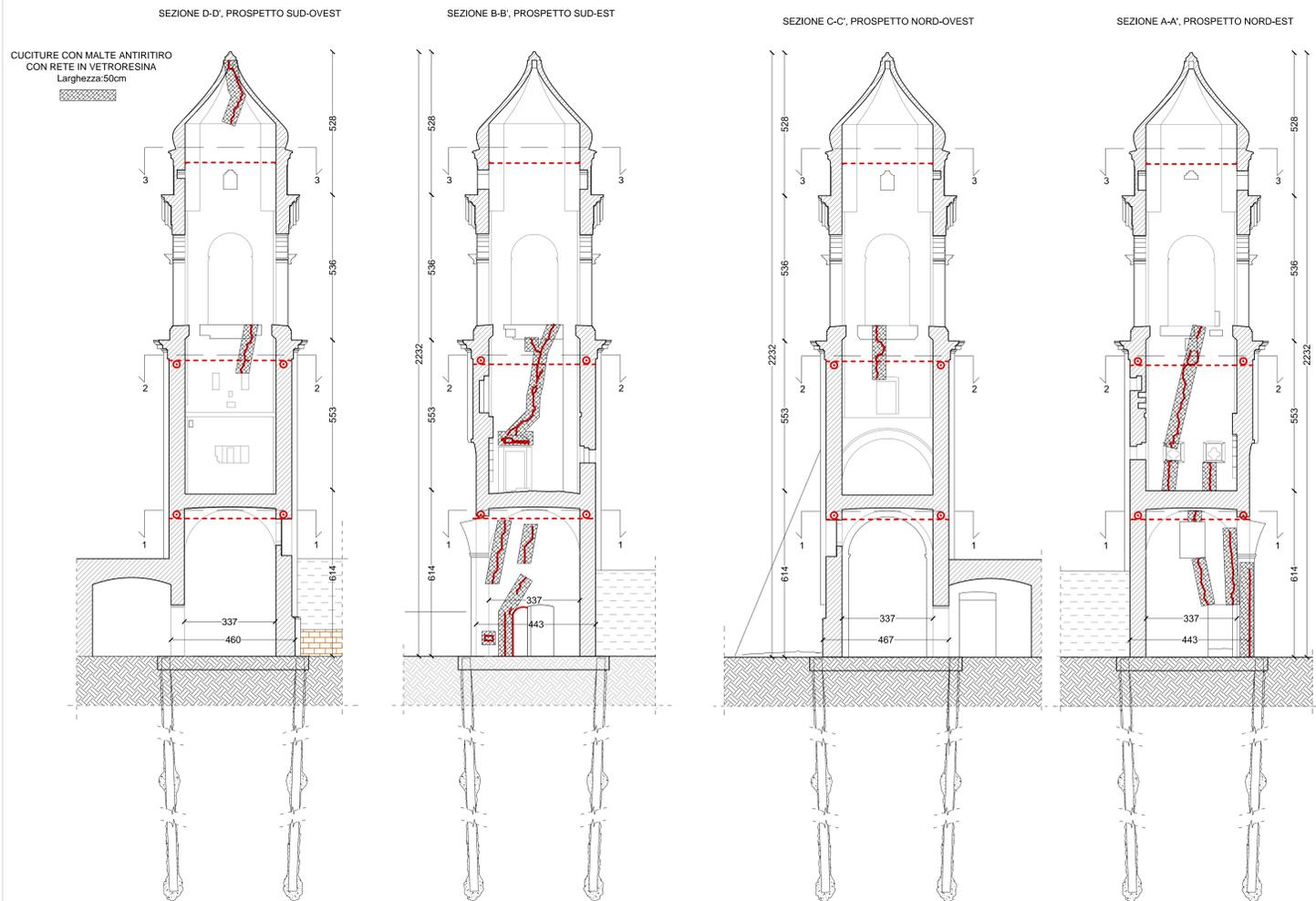
Sezione pali indicativa, per il posizionamento fare riferimento alla sezione di base
